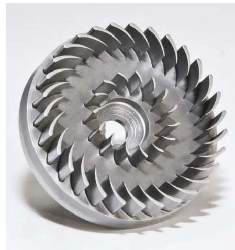
Формирование контуров лопастей и обработка поверхности (шероховатость спереди и сбоку) выполняются за один технологический этап. Источник: Extrude Hone
