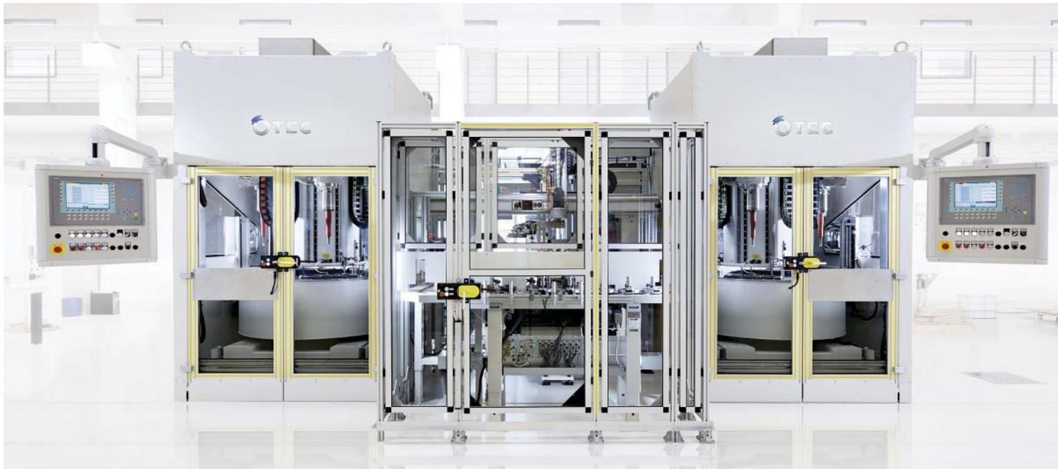
Система обработки потока с импульсным приводом, которая интегрирована в серийное производство в автомобильной промышленности, используется для полностью автоматизированного удаления заусенцев, округления и сглаживания распресвалов. Уменьшение высоты от пика до впадины, например, от 0,2 до 0,1 мкм, достигается менее чем за одну минуту.
