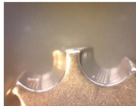
С помощью плазменной полировки, для которой используется электролит, состоящий из 98% воды и 2% соли, удаляются заусенцы, а также следы фрезерования и неровностей материала, и получаются гладкие однородные поверхности.
