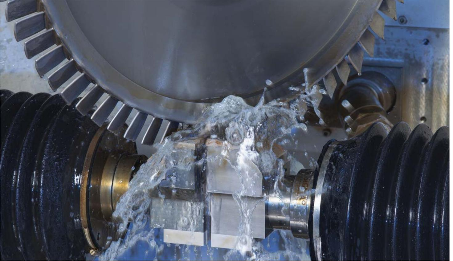
В случае ECM происходит обмен зарядами между катодом и анодом (компонентом) в водном растворе электролита, с помощью которого заготовка точно обрабатывается целевым образом.
