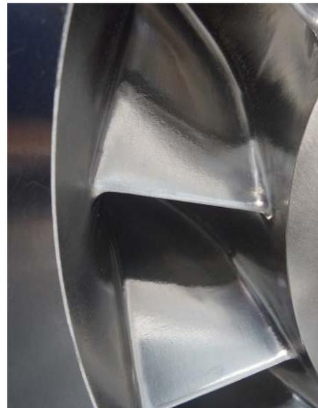
С помощью абразивной обработки шероховатость поверхности может быть улучшена в 5–8 раз по сравнению с ее исходным состоянием. Поверхностное натяжение уменьшается одновременно. Источник: 4MI GmbH
