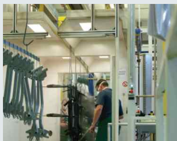
Рис. 2. Полностью автоматизированная камера для нанесения покрывного лака оборудована тремя автоматическими пистолетами и двумя площадками для работы в ручном режиме
