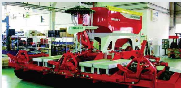
Рис. 1. Сельхозки имеют рабочую ширину до 6 м и вес до 10 т. Они производятся из листовой стали путем кройки, штамповки, формовки, сварки, окрашивания и сборки
