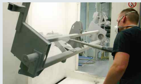
Рис. 3. Спектр используемых деталей на 70% состоит из сварных конструкций. В кабине для грунтовки покрытие наносится вручную
