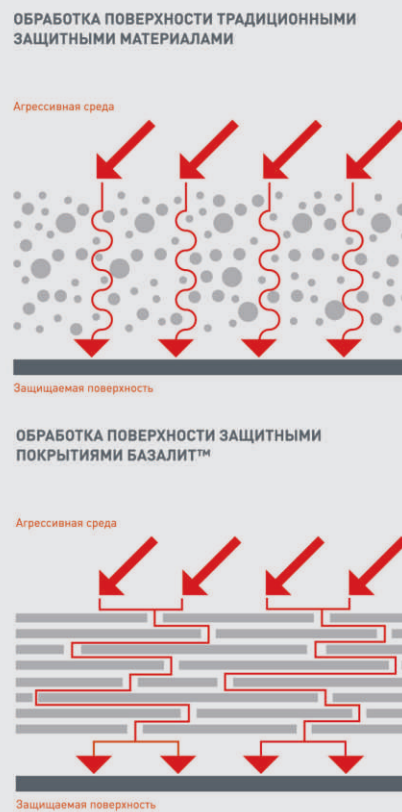
Рис. 2 Снижение скорости диффузии агрессивной среды в случае применения защитных покрытий БАЗАЛИТ™
