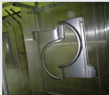
Фото 2 Детали с фосфатным покрытием Chemetall
