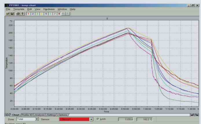
Рисунок 2. Динамические термохарактеристики ИК-печи полимеризации
