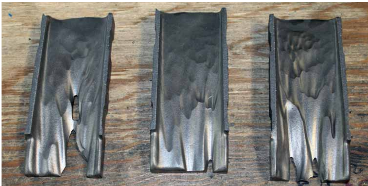
Рисунок 10. Характерный износ лопаток турбин от воздействия пыли
