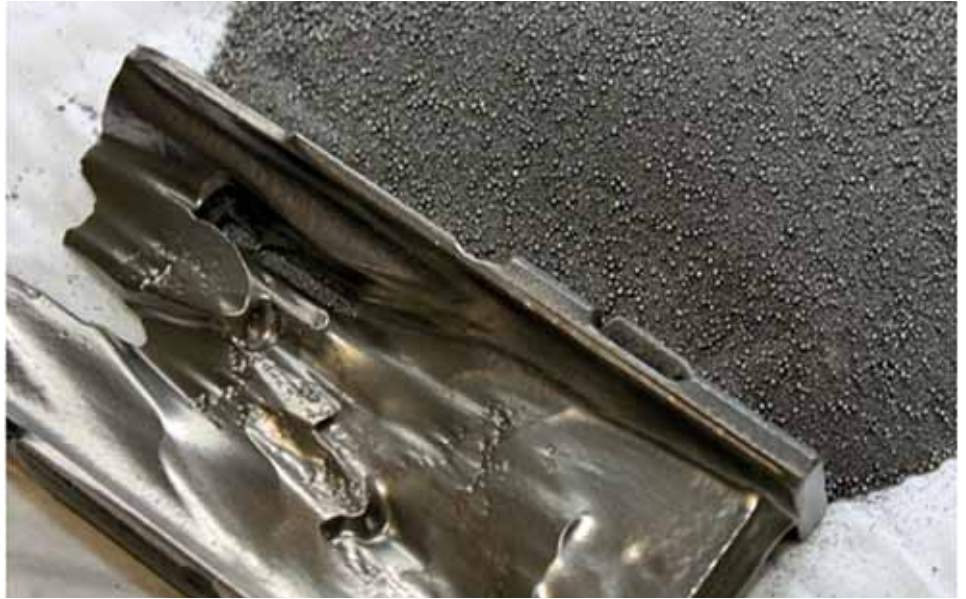
Рисунок 12. Пыль в рабочей смеси и характерный износ лопатки дробебетной турбины – последствия масляных загрязнений
