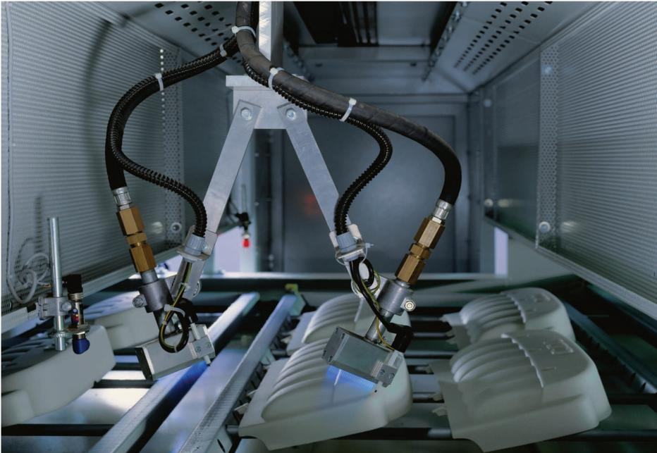
Плазменная обработка приводит к возникновению полярных групп на поверхности неполярной подложки, что обеспечивает хорошую адгезию при окраске
