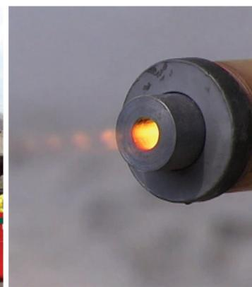
Рис. 12. Сопло реактивной горелки термоабразивной установки
