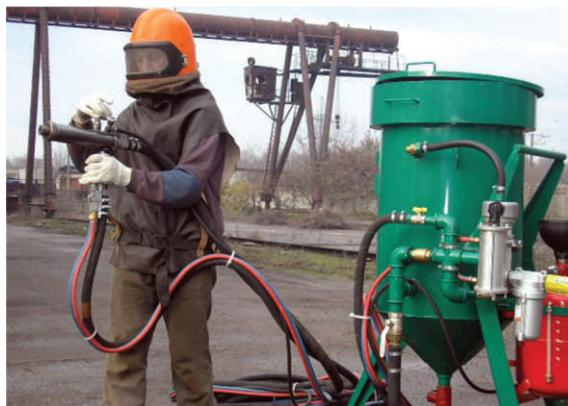
Рис. 11. Термоабразивная установка TAU-200
