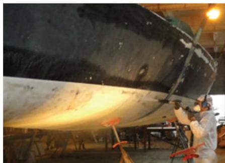
Рис. 6. Обработка подводной части корпуса судна системой EсоQuip
