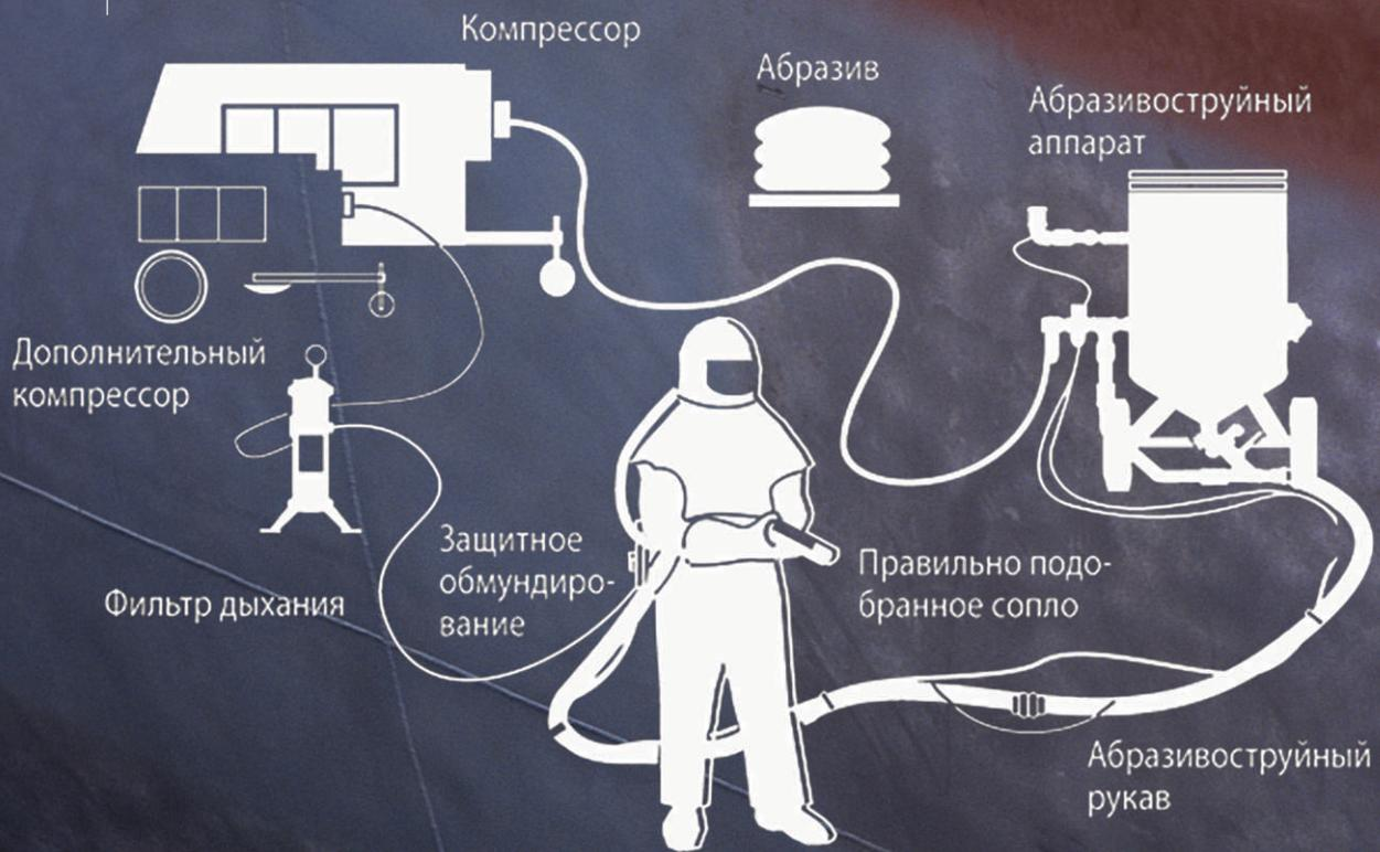
Рис. 1. Принципиальная схема абразивоструйной обработки
