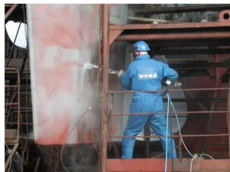
Рис. 13. Гидроструйная очистка сверхвысоким давлением
