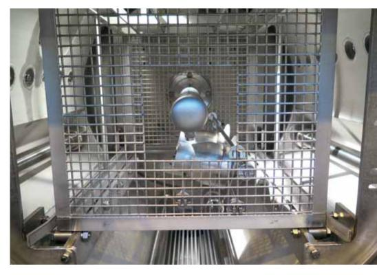
Когда очистка осуществляется струей под высоким давлением, система оснащена дополнительным высоконапорным насосом и разбрызгивающим соплом. Одно из них размещено на внутренней стенке рабочей камеры, другое – установлено в центре. Эта конструкция обеспечивает как внутреннее, так и внешнее распыление одновременно или в чередующемся режиме
