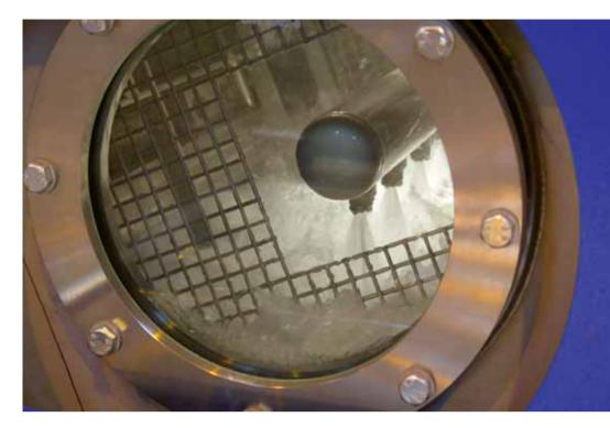
Новая возможность струйной очистки под высоким давлением для машин, работающих на основе растворителей, таких как EcoCcore, позволяет выполнять процессы распыления и промывки под давлением при регулируемом давлении вплоть до 16 бар. Таким образом достигаются улучшенные результаты очистки деталей с геометрически сложной конфигурацией и большого количества деталей, которые очищаются все вместе
