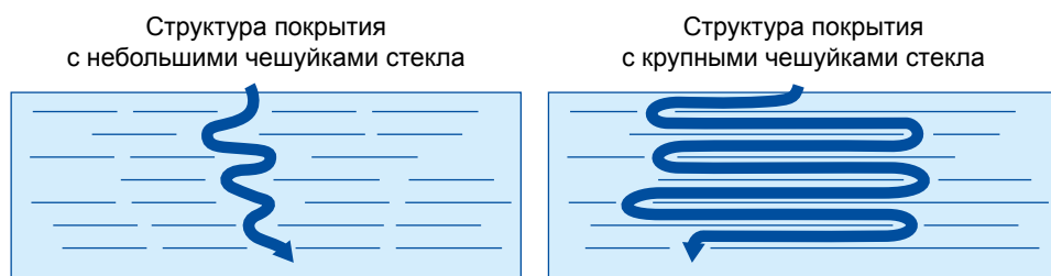
Рисунок 3. Разная степень защиты у покрытия с чешуйчатым стеклом
