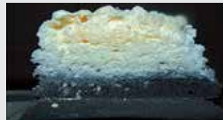
Рисунок 1. Покрытие НЕОФЛЭЙМ®513 толщиной 1 мм после испытания в условиях стандартного пожара
