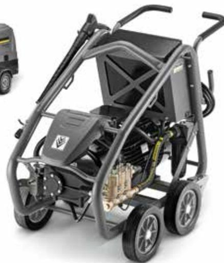
Для проведения гидроабразивного метода очистки применяются аппараты высокого давления с абразивными насадками. В качестве абразивного материала используется гранатовый или кварцевый песок. Фракция песка 0,5–3,0 мм. Во всех случаях абразивный материал должен быть сухим. Абразивная очистка производится по классу Sa1.0–Sa2.5, стандартам ISO 8501.
