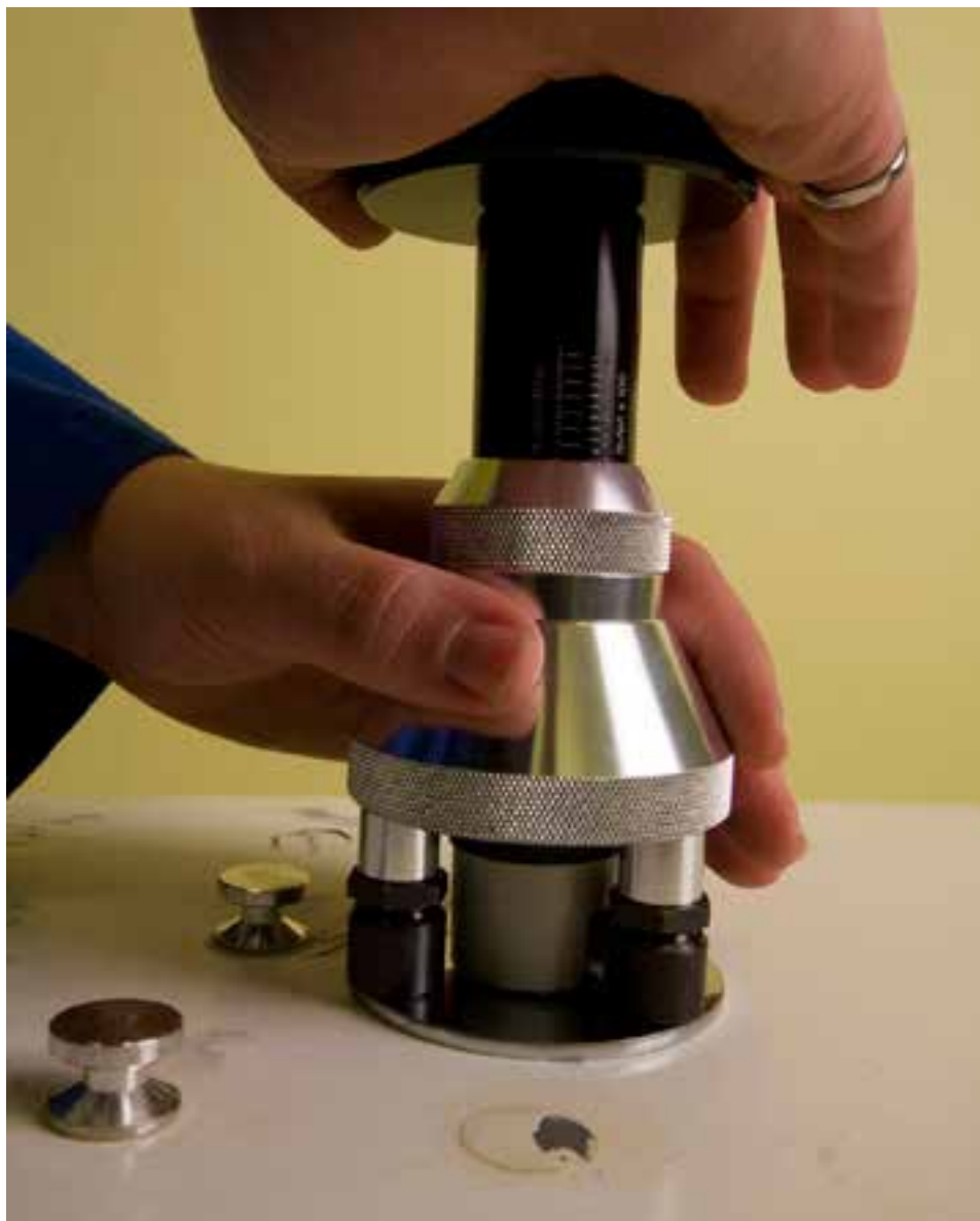
Рис. 5. Измерение адгезии покрытия методом отрыва
