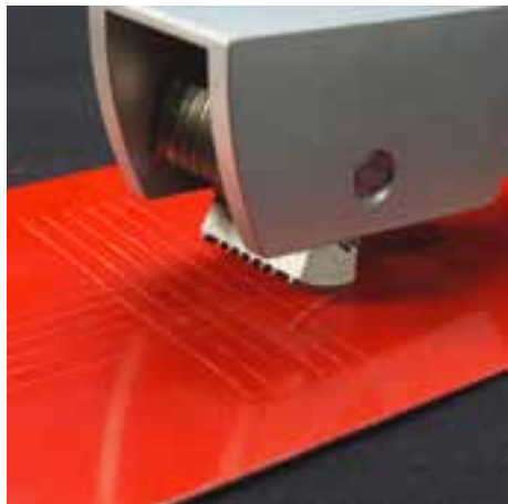
Рис. 1. Определение адгезии методом решетчатого надреза
