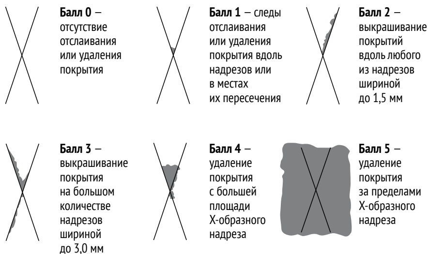
Рис. 4. Оценка результатов испытаний адгезии методом X-образного надреза согласно ГОСТ 32702.2
