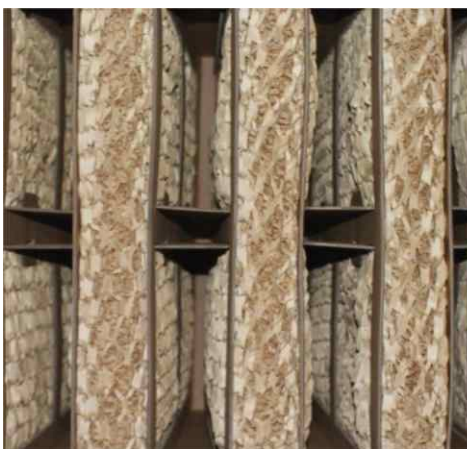
Фото 3 Там, где речь идет об очистке избыточного распыления, имеется тенденция к использованию сухой очистки. В этом случае используются различные концепции: щетки, электростатики, порошок и, как показано здесь, специальные картонные шаблоны. Источник изображения: Neufilter
