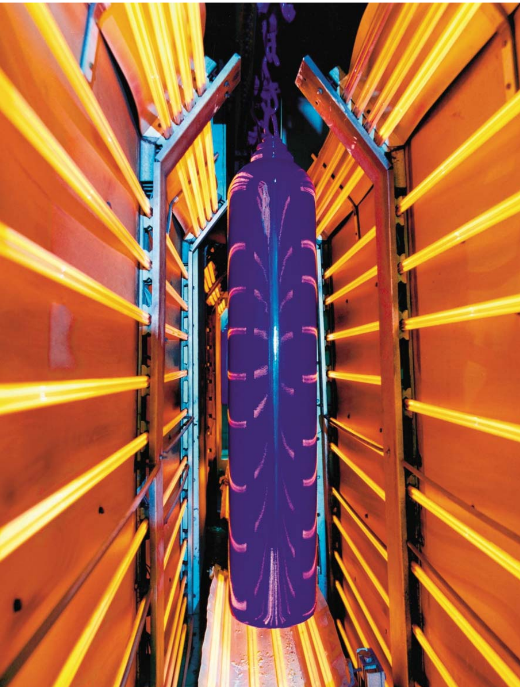
Инфракрасная сушка может использоваться в качестве альтернативы или дополнения, а также подходит для чувствительных к температуре заготовок. Источник: Heraeus Noblelight
