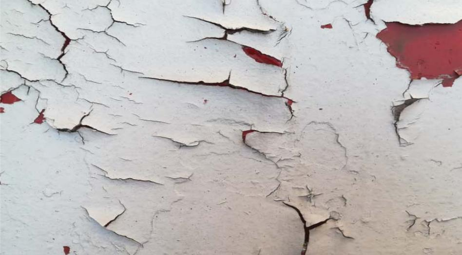
Растрескивание покрытия – самый неприятный и опасный из описанных дефектов, когда отдельная часть или вся площадь детали покрываются глубокими трещинами, сводящими на нет всю проделанную работу.
