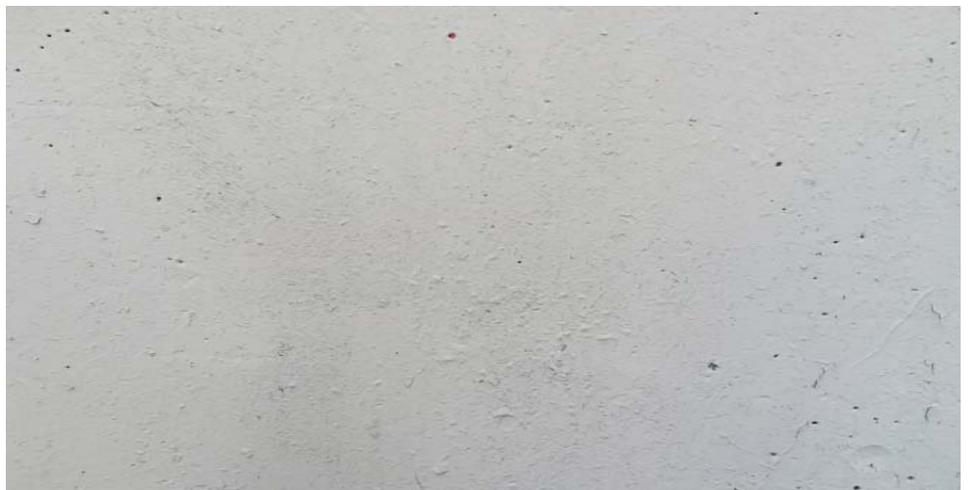
Сорность проявляется как наличие множества микроскопических зерен, хаотично распределенных на поверхности окрашенной конструкции или детали.
