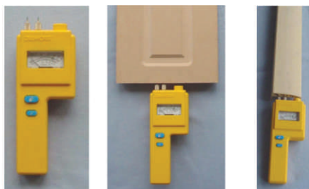
Рис. 3. Измерение содержания влажности в панели МДФ и прессованном древесном материале
