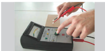
Рис. 2. Измерение поверхностного сопротивления
