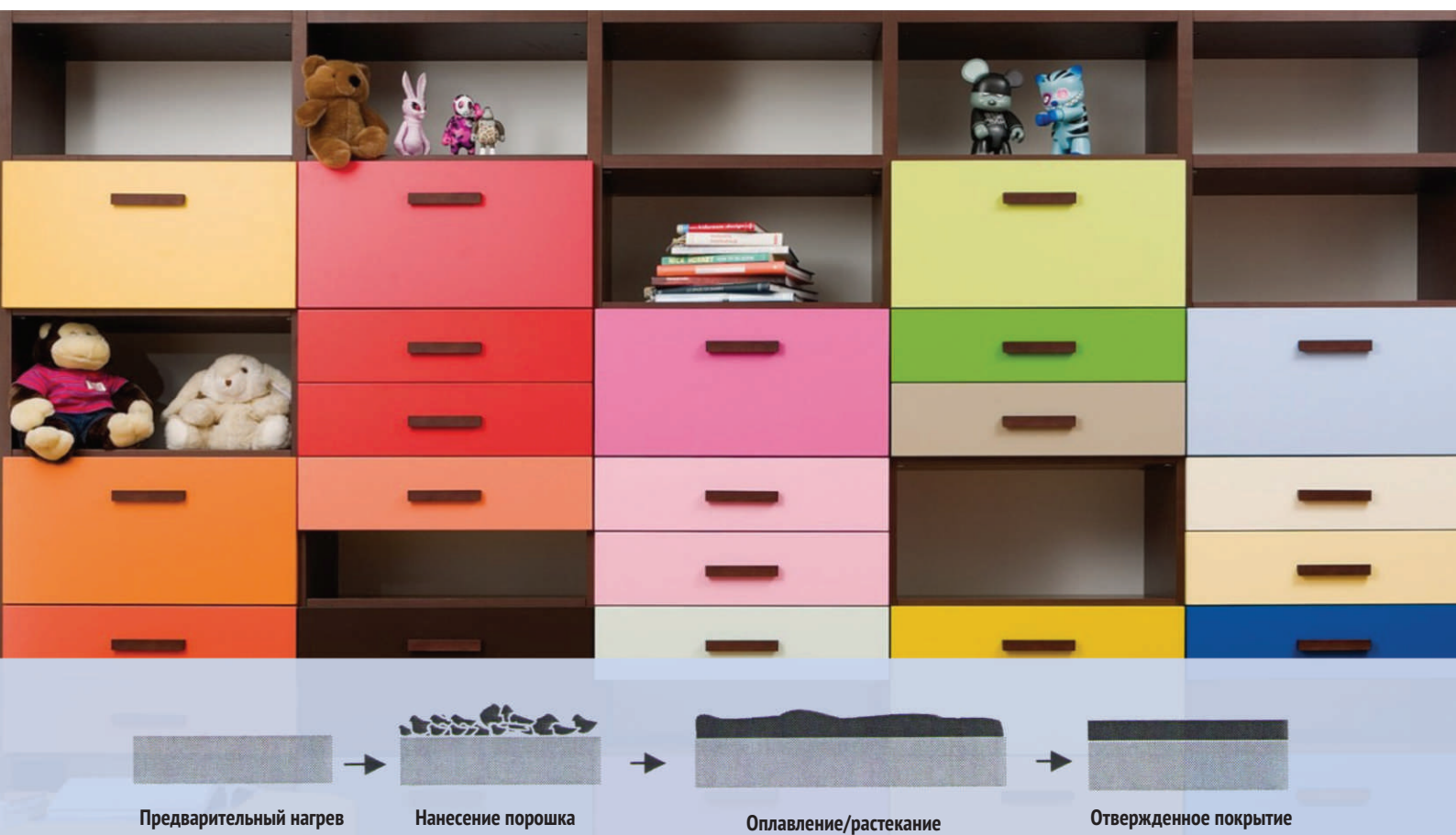
Рис. 5. Процесс применения порошка, отверждаемого при низких температурах на МДФ
