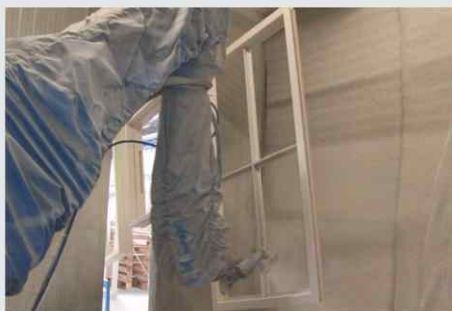
Последовательность движений, выполняемых роботом для нанесения краски на окна, автоматически выдается системой программирования 2D.
