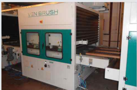
Новый модуль позволяет автоматически шлифовать длинные края дверей с обеих сторон.
