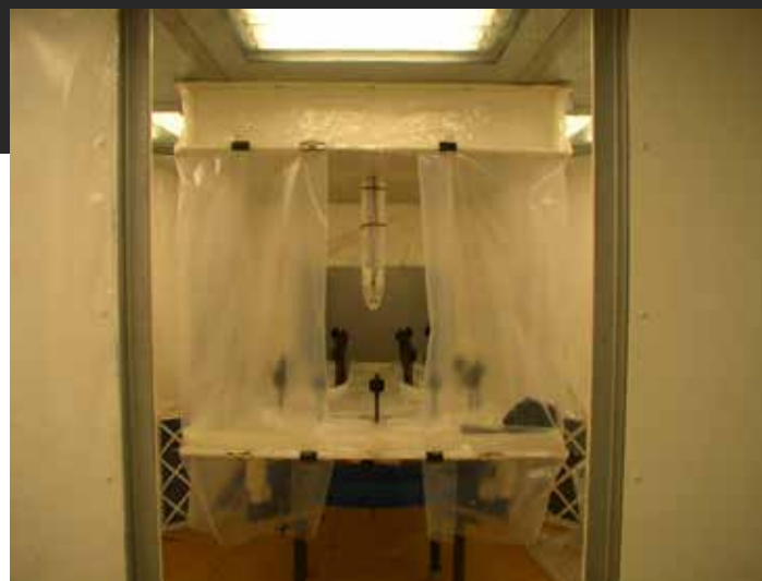
Фото 2. Вид окрасочной камеры с турбодиском
