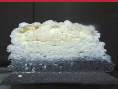
Рис. 1. Покрытие НЕОФЛЭЙМ® 513 толщиной 1 мм после испытания в условиях стандартного пожара
