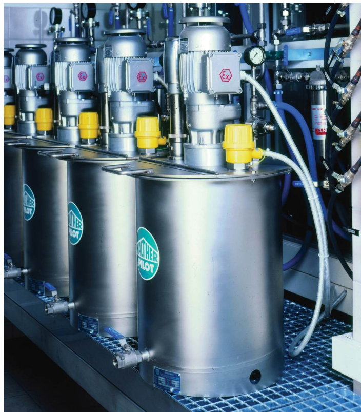
Фото. 3. Системы подачи краски, компания Walther Spritz- und Lackiersysteme
