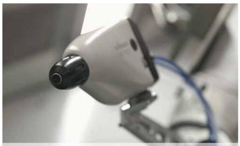
Использование современных электростатических пистолетов-распылителей повышает эффективность нанесения покрытия и снижает избыточное распыление, минимизируя тем самым расход материала
