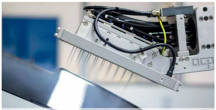
Альтернативные методы очистки, такие как снегоструйная технология, позволяют снизить затраты на очистку, а также интегрировать полностью автоматизированные процессы очистки в линию окраски. Помимо этого, холодная очистка может устранить проблемы с адгезией Источник: системы АСР
