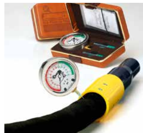
Рис. 1. Манометр с иглой для измерения давления на сопле
