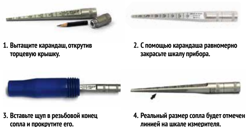
Рис. 2. Прибор для измерения внутреннего диаметра абразивоструйного сопла
