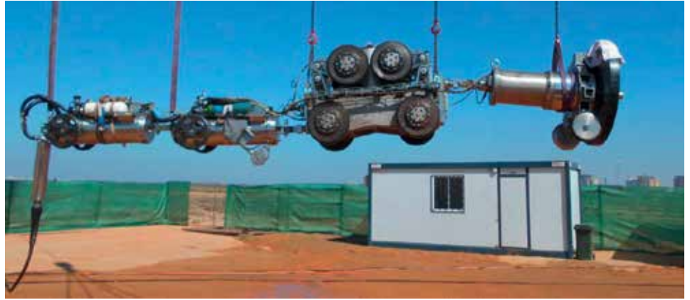
Рисунок 2. Внутритрубная диагностика методом ультразвуковой панорамной дефектоскопии
