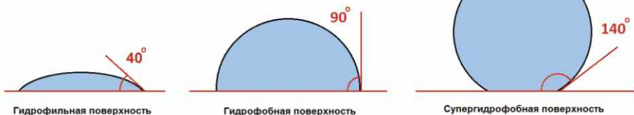
Рис. 1. Поверхности с различным углом контакта: угол Янга, или краевой угол смачивания
