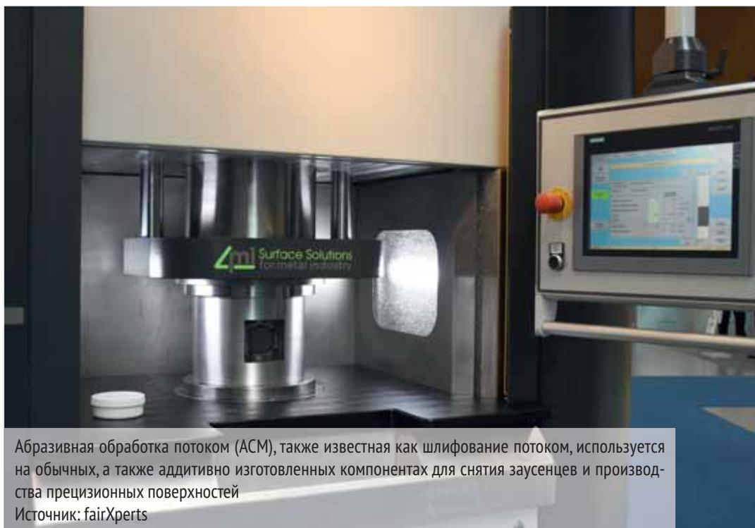
Абразивная обработка потоком (АСМ), также известная как шлифование потоком, используется на обычных, а также аддитивно изготовленных компонентах для снятия заусенцев и производства прецизионных поверхностей
