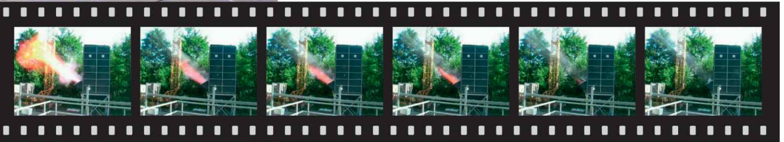
Тестирование клапана сброса избыточного давления взрыва для сепаратора Источник: Keller Lufttechnik, Kirchheim unter Teck, Германия
