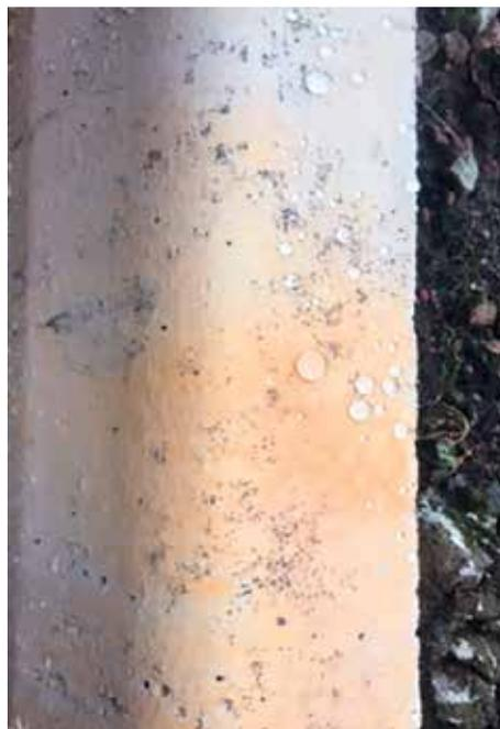
Рис. 10. Бордюр слева без обработки супергидрофобным покрытием, справа с обработкой супергидрофобным покрытием
