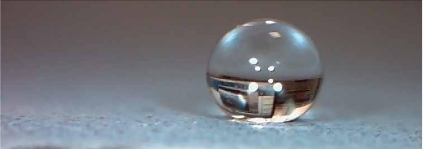
Рис. 9. Микрофотография капли воды на супергидрофобном покрытии
