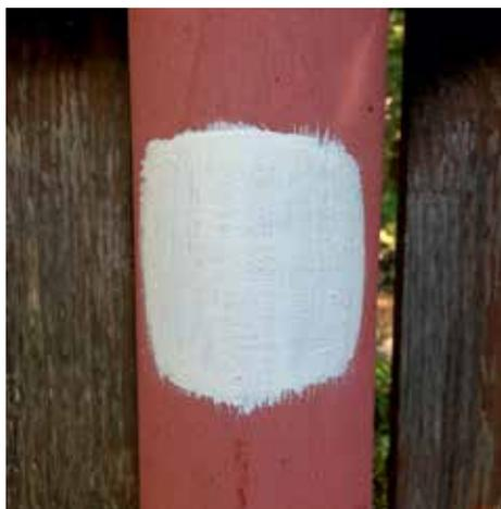
**Рис. 2.** Покрытие на основе винилированного алкида после 3 лет эксплуатации в реальных атмосферных условиях на металлической подложке
