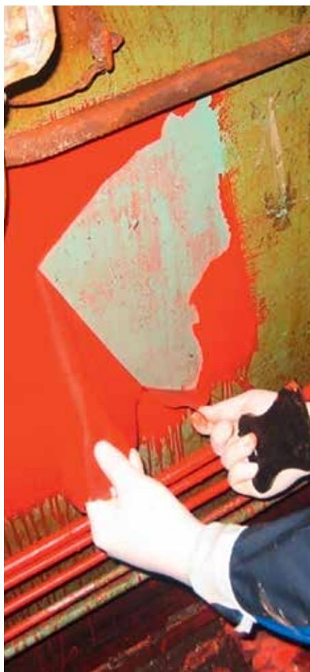
Рис. 8. Защитный полимерный состав сразу после нанесения и в процессе его снятия с поверхности
