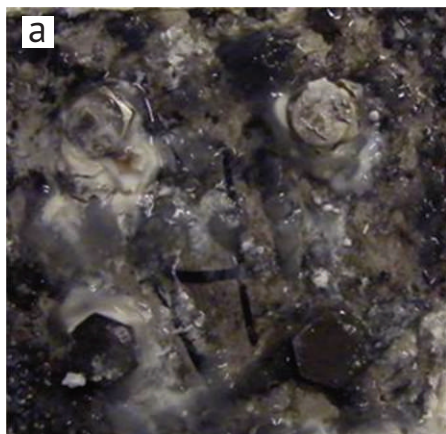
Рис. 1. Внешний вид образцов «алюминий–углепластик» после экспозиции 3000 ч в камере соляного тумана: а) без защиты; б) с комплексной защитой, включающей неорганические покрытия, разделительные слои и лакокрасочное покрытие на основе эмали ВЭ-69
