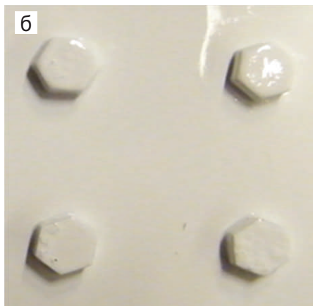
Рис. 1. Внешний вид образцов «алюминий–углепластик» после экспозиции 3000 ч в камере соляного тумана: а) без защиты; б) с комплексной защитой, включающей неорганические покрытия, разделительные слои и лакокрасочное покрытие на основе эмали ВЭ-69
