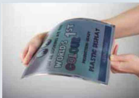
Фото 2. Гибкий электрофоретический цветной экран электронного устройства для чтения книг или планшета с системой плат на органических транзисторах
