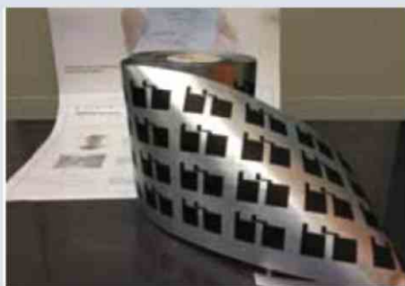
Фото 1. Плоские аккумуляторы на основе гидрида никеля, нанесенные на рулонную пленку
