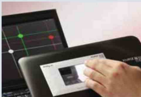
Фото 4. Демонстратор емкостной многоточечной сенсорной панели с прозрачной электропроводящей поверхностной пленкой
