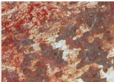
**Коррозия** (от лат. *corrosio* – разъедание) – это реакция химического или физико-химического взаимодействия материала с окружающей средой, вызывающая его разрушение. Она приводит как к изменениям в самом материале, так и к ухудшению рабочих свойств узлов, деталей и конструкций, изготовленных из него. Хотя коррозию чаще всего связывают с металлами, ей подвергаются также камни, бетон, дерево, пластмассы и другие полимерные материалы.
